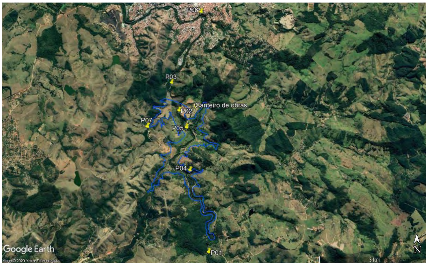
Figura 3.1-1. Rede de Amostragem do Monitoramento da Qualidade das Águas Superficiais e dos Sedimentos – Barragem Pedreira.
