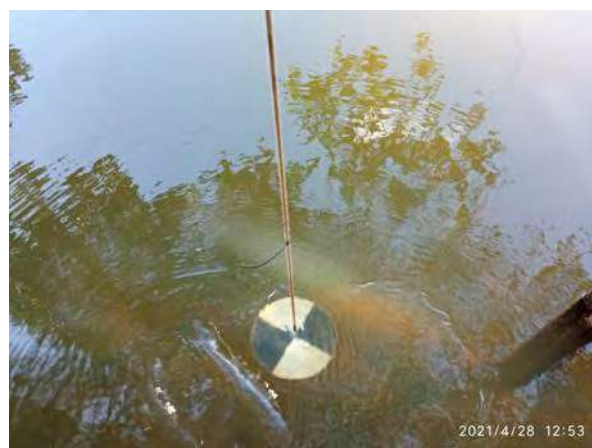
Foto 10 – Medição da transparência da água (Data: 28/04/2021).
